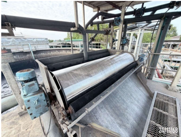
รูปที่ 2-3 ลูกกลิ้งตะแกรงดักขยะ (Rotary Screen)
