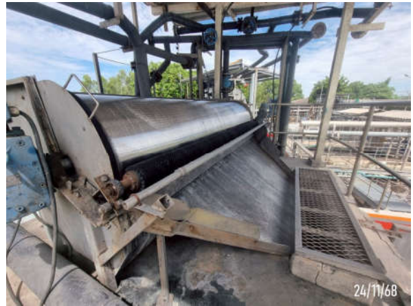
รูปที่ 2-3 ลูกกลิ้งตะแกรงดักขยะ (Rotary Screen)
