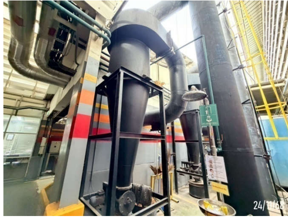
Dry scrubber ของระบบให้ความร้อนของ Thermal Oil Boiler ที่ใช้ Diesel Oil (Thermo Pack)
